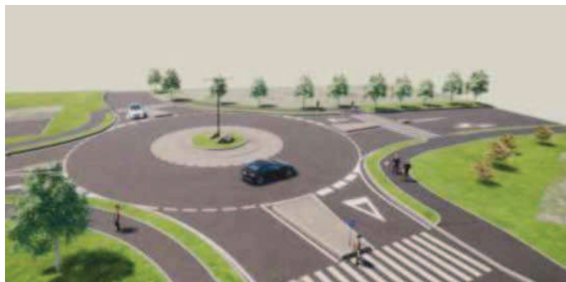
Enopasovno štirikrako krožno križišče z zunanjim radijem 11,0 m.
